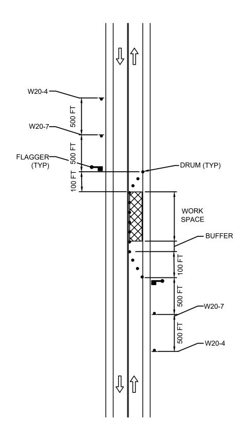
MINIMUM LENGTH OF LONGITUDINAL BUFFER IS EQUAL TO THE STOPPING SIGHT DISTANCE AT THE POSTED SPEED LIMIT AND CAN BE DETERMINED FROM THE FOLLOWING TABLE:
